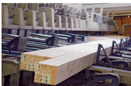
Das regionale Rundholz wird bei Schmelter zu Bauholz (Werk Saalhausen) sowie KVH und BSH (Werk Oedingen) verarbeitet
